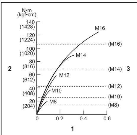
1. Tempo de aperto (segundos) 2. Torque de aperto 3. Torque de aperto apropriado para os diferentes diâmetros de parafusos passantes
